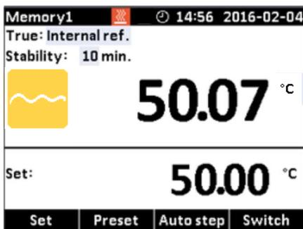
Der Kalibrator verfügt über einen Satz interner Stabilitätskriterien, die er erfüllen muss, ehe Stabilität angezeigt wird. Die Stabilitätszeit kann über die internen Stabilitätskriterien hinaus eingestellt werden.
