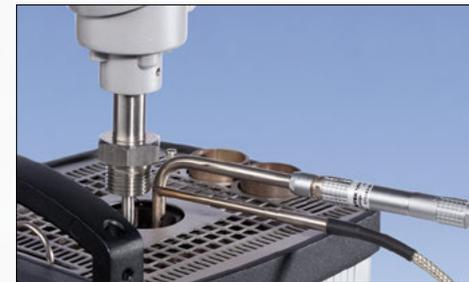
Die neuen STS-200 Referenzsensoren und der DLC-Sensor besitzen ein spezielles Design. Beide haben einen Winkel von 90° und sind maßgefertigt, sodass diese lediglich geringfügig höher sind als die Oberkante des RTC Kalibrators.
