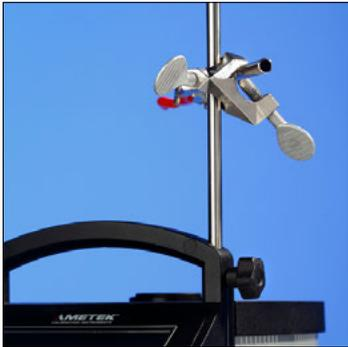
Die neue integrierte Haltestange ist ein Teil der Gewichtsreduzierungsphilosophie. Sie ist leicht und kann ganz einfach am RTC montiert werden. Zwei Befestigungsbohrungen befinden sich am Kalibrator, um die Haltestangen anzubringen. Auch wenn das Gewicht um 50 % reduziert wurde, ist die Haltestange doch sehr stabil positioniert.
