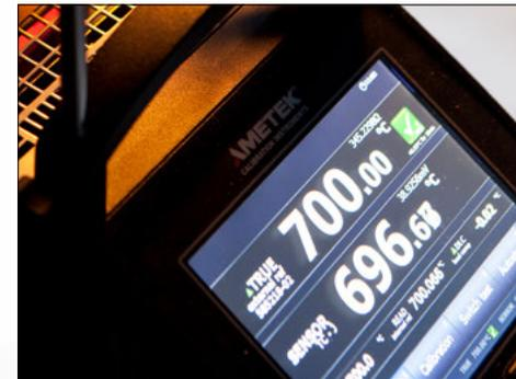
Das neue 5,7" VGA Farbdisplay ist äußerst leicht zu lesen. Die wichtigsten Temperaturen, wie bspw. SET, READ, TRUE und SUT (sensor under test) werden stets sowohl bei sämtlichen Programmstufen als auch bei dem Kalibrierablauf angezeigt.
