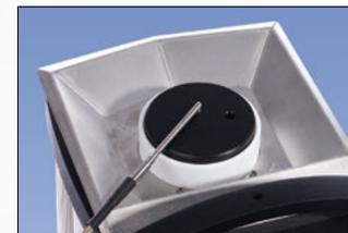
Die neuen STS-200 Referenzsensoren und der DLC-Sensor besitzen ein spezielles Design. Beide haben einen Winkel von 90° und sind maßgefertigt, sodass diese lediglich geringfügig höher sind als die Oberkante des RTC Kalibrators.
