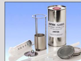
Das Flüssigkeitsbad-Set für RTC-158/250 enthält einen Sensorkorb, 2 Deckel, ein Magnet, ein magnetischer Entferner, ein Flüssigkeitsablassschlauch und 0,75 l Silikonöl.
