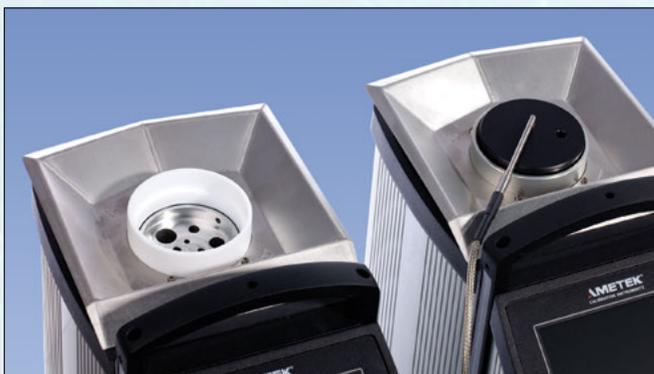
Der RTC-158/250 wird mit einer 160 mm (6,3 Zoll) tiefen Hülse mit einem Durchmesser von 63,5 mm (2,5 Zoll) geliefert und kann als Trockenblockkalibrator und als Flüssigkeitsbadkalibrierung mit einem magnetischen Mischer angewandt werden.
