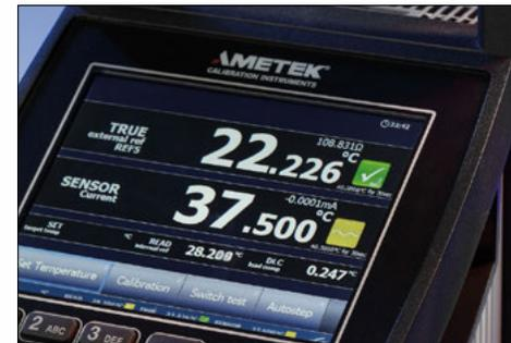
Das neue 5,7" VGA Farbdisplay ist äußerst leicht zu lesen. Die wichtigsten Temperaturen, wie bspw. SET, READ, TRUE und SUT (sensor under test) werden stets sowohl bei sämtlichen Programmstufen als auch bei dem Kalibrierablauf angezeigt.
