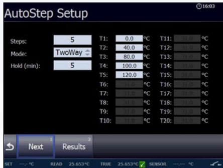
Es können bis zu 20 verschiedene Temperaturschritte inkl. Haltezeit programmiert werden. Nach Abschluss einer Autoschritt-Routine kann der Anwender die Ergebnisse für den Prüfling auf dem RTC-Display leicht ablesen. Es können bis zu 20 Autoschritt-Ergebnisse gespeichert werden. Das Merkmal „Soll-Temperatur einstellen“ (Set Temperature) ermöglicht dem Benutzer, exakt die gewünschte Temperatur mit einer Auflösung von 0,001° einzustellen.
