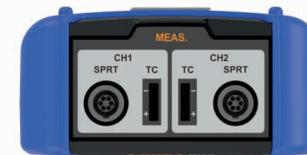
Zwei analoge Messkanäle, die gleichzeitig angezeigt werden können
