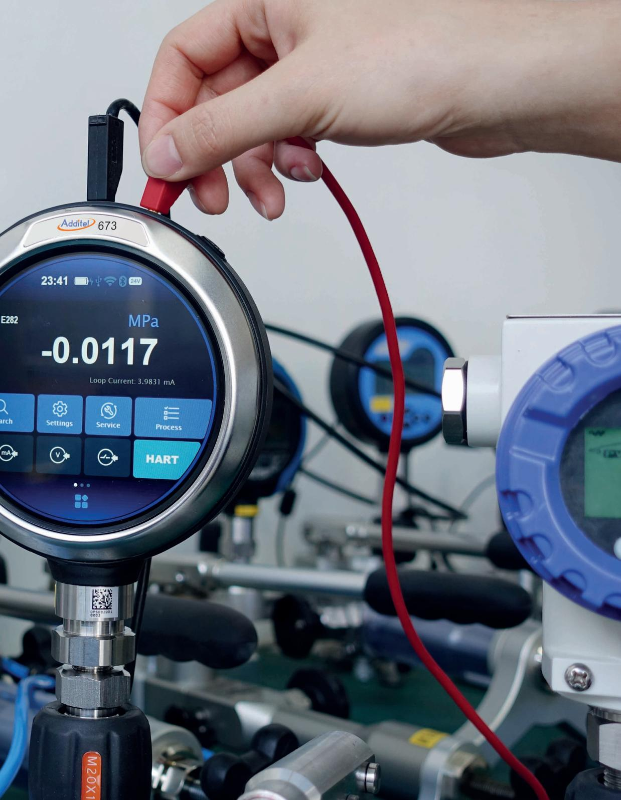
Vollständiger HART-Feldkommunikator (optional) für Druckkalibrierungslösungen für Transmitter über einen großen Druckbereich
