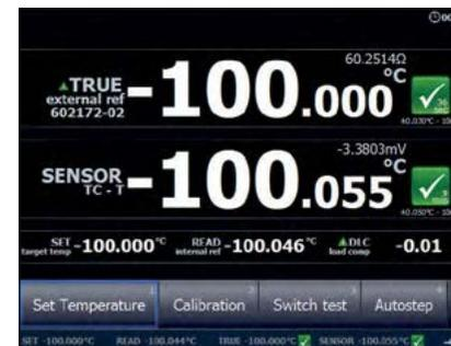
Das Modell B ist mit einem eingebauten, präzisen Messkreis für den Prüfling (Input) ausgestattet, welcher Messungen für nahezu jeden Typ von Temperatursensoren ermöglicht, wie z. B.: Widerstandsthermometer (RTD), Thermoelemente (TC), Transmitter, Strom (mA), Spannung (V), und Thermostate.
