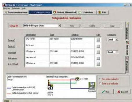
JofraCal ist eine höchst vielseitige Kalibriersoftware, welche zusammen mit den RTC Kalibratoren geliefert wird. Die Software gewährleistet eine einfache Kalibrierung nahezu sämtlicher Arten von Temperatursensoren, wie bspw. RTD's, Thermoelemente, Transmitter und Temperaturschalter. Desweiteren kann sie für Druckkalibrierungen genutzt werden, wie z.B. Druckmanometer und Druckschalter.
