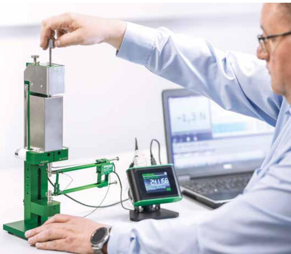
Werkstoffprüfmaschinen für Zug- und Druckkraft kalibrieren wir vor Ort nach DIN EN ISO 7500-1 mit Kraftaufnehmern der Klasse 00 und Klasse 0,5 sowie mit Belastungskörpern der Klasse M1.
